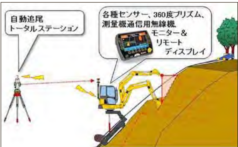
3D法面掘削システムのイメージ
